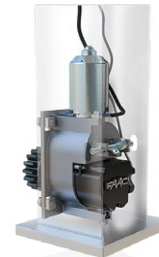
*CYCLO 720 – motorisation silencieuse pour les portails coulissants, y compris antagonistes. Il est doté de mécanismes brevetés pour réduire le bruit et les vibrations. Le kit comprend un moteur électromécanique avec unité de commande intégrée E720, une base de montage, un module radio XF 868, une télécommande noire XT4 868 SLH LR et deux cellules photoélectriques XP 20B D.*
